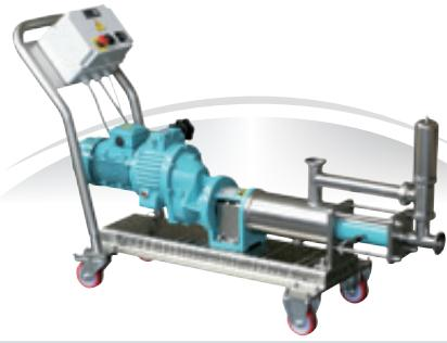
► Elettropompa serie MN in acciaio inox con motovariatore di giri a bagno d'olio con by pass di sovrappressione completa di dispositivo contro la marcia a secco.
